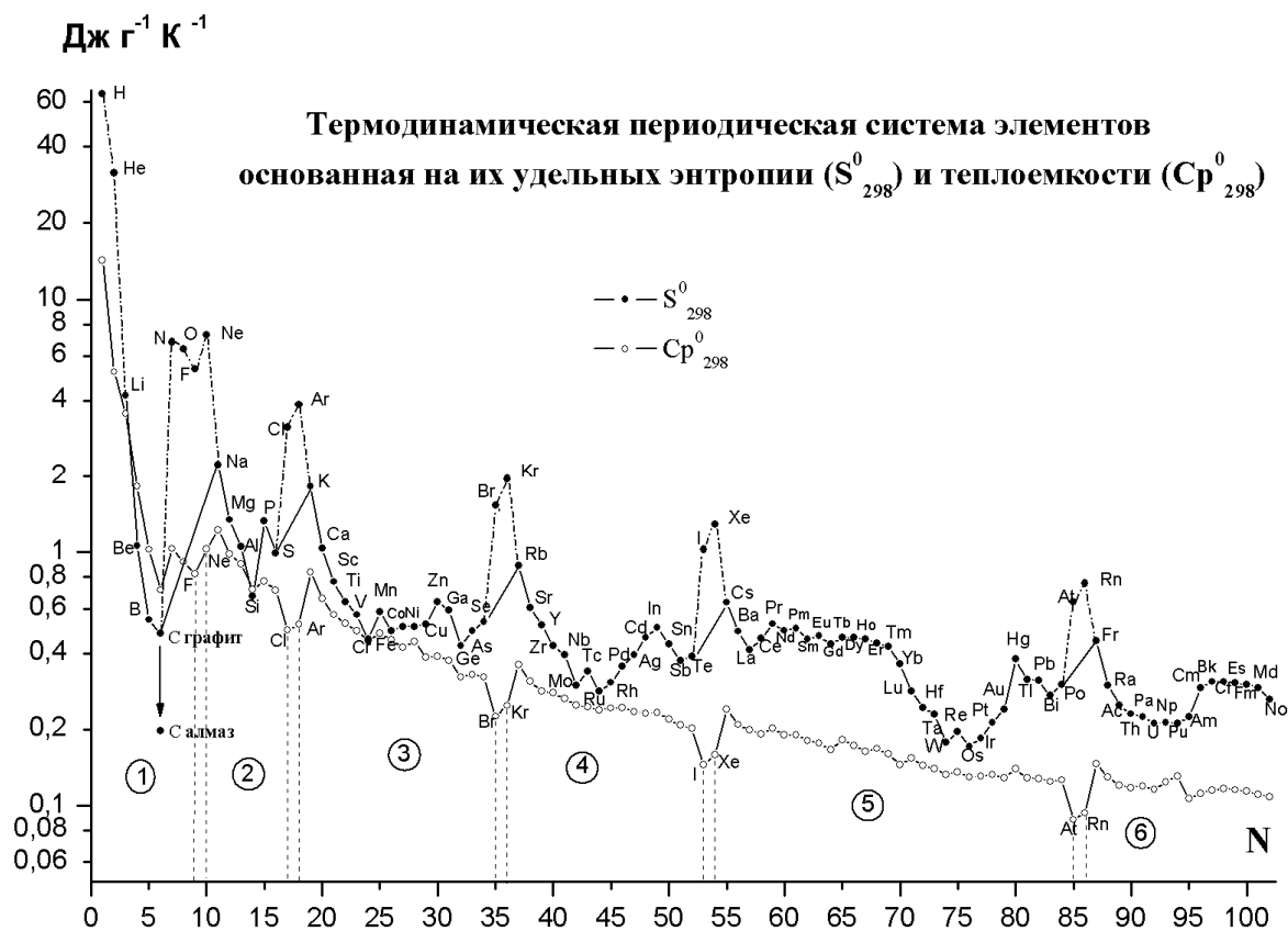
Рис. 1. Химические элементы в периодической системе (цифры в скобках – периоды) с разделением их по энтропии на элементы газов и флюидов (соединены штрихпунктирными линиями) и элементы твердых и жидких фаз (соединяются сплошными линиями). Линии отрицательного наклона соединяют оксифильные элементы, линии положительного наклона объединяют элементы сульфурофильной спецификации.
