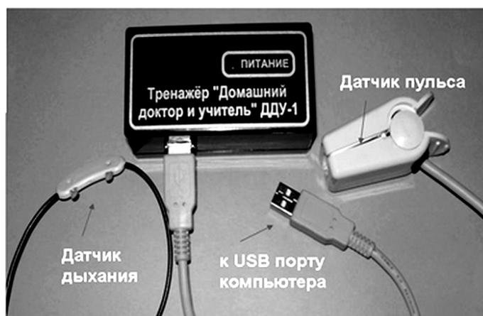
Рис. 3. Программно-аппаратное устройство хронодиагностики и биоуправляемой хронофизиотерапии
