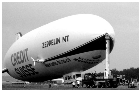
Современный немецкий дирижабль «Цепелин НТ» (Zeppelin NT) у передвижной телескопической причальной мачты, установленной на шасси четырёхосного автомобиля. Фото с сайта http://dic.academic.ru/dic.nsf/ruwiki/755963
