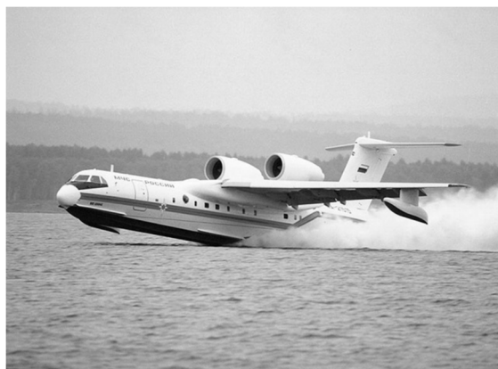
Отечественный многоцелевой самолёт-амфибия Бе-200. Максимальная взлётная масса: с воды – 40 тонн; с суши – 42 тонны. Фото с сайта http://www.pribaikal.ru
