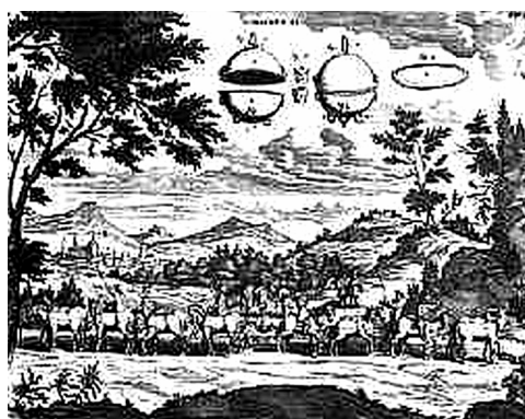
Магдебургский эксперимент О. фон Герике. Иллюстрация из книги «Experimenta nova, ut vocantur, Magdeburgica de vacuo spatio»
